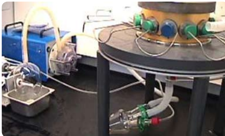
Mesin Penguji Kandungan Tar dan Nikotin dalam asap rokok
